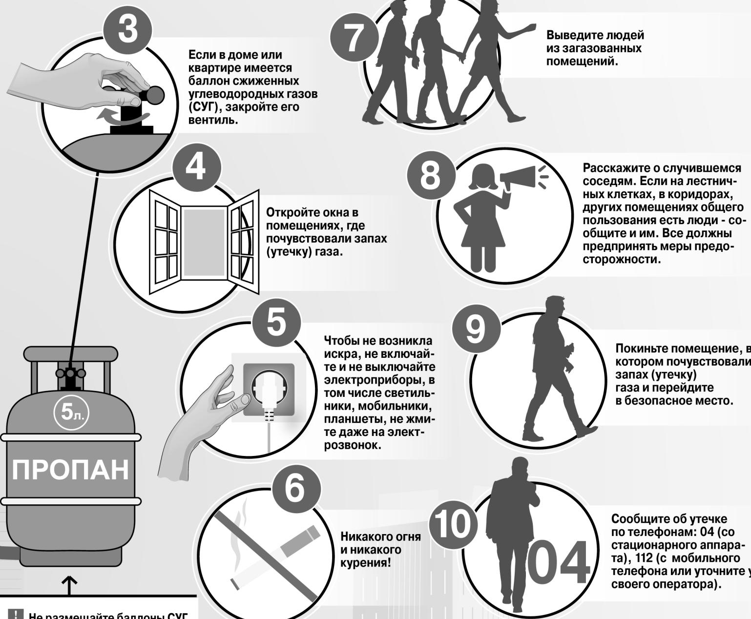
! Не размещайте баллоны СУГ ближе 0,5 м к газовой плите и 1 м к отопительным приборам (радиаторам отопления или печам).
