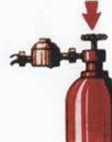
**ЗАКРЫТЬ КРАН НА ОТВОДЕ К ГАЗОВЫМ ПРИБОРАМ**
