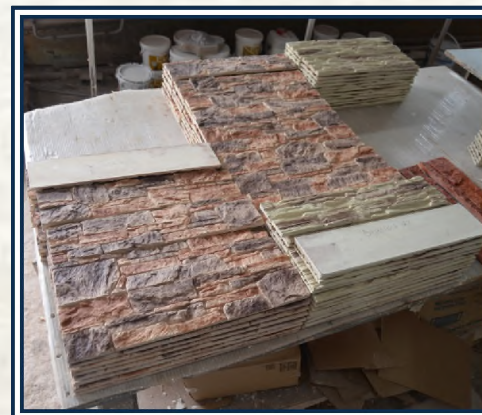
Производство облицовочного искусственного камня
