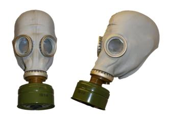
Гражданский противогаз ГП-5 предназначен для защиты человека от попадания в органы дыхания, на глаза и лицо радиоактивных, отравляющих, аварийно химически опасных веществ и бактериальных средств. Принцип защитного действия основан на предварительной очистке (фильтрации) вдыхаемого воздуха от вредных примесей. Противогаз ГП-5 состоит из фильтрующее поглощающей коробки и лицевой части (шлем-маска).
